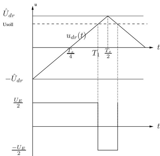
Abbildung 2: Pulsweitenmodulation
