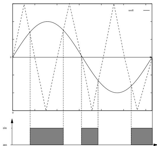
Abbildung 1: Unterschwingverfahren
